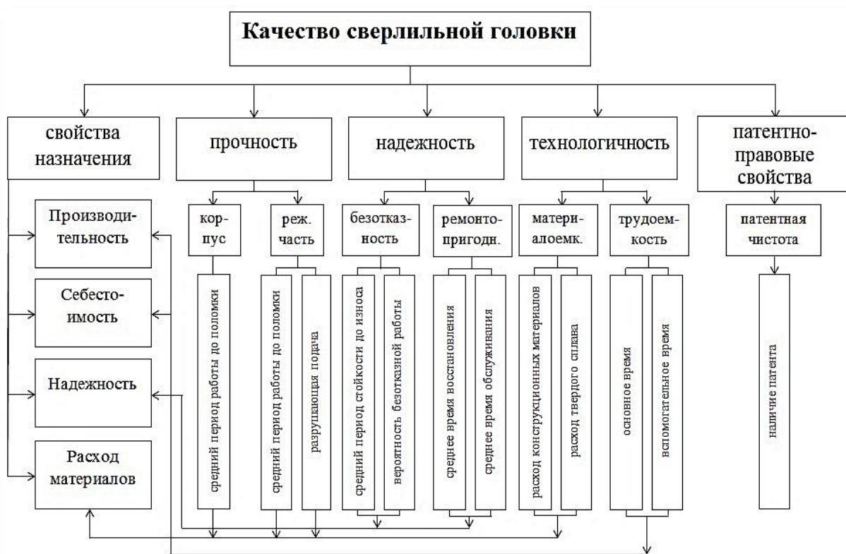
Рис. 1. Иерархическая структура свойств, составляющих качество инструмента для глубокого сверления на стадии его эксплуатации
